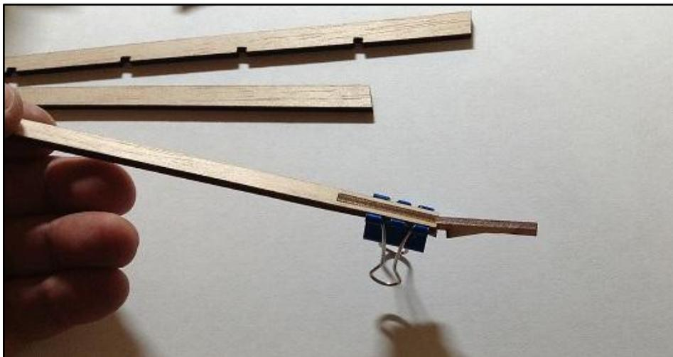
Собираем конструкцию «насухо» на чертеже и проливаем стыки клеем.
